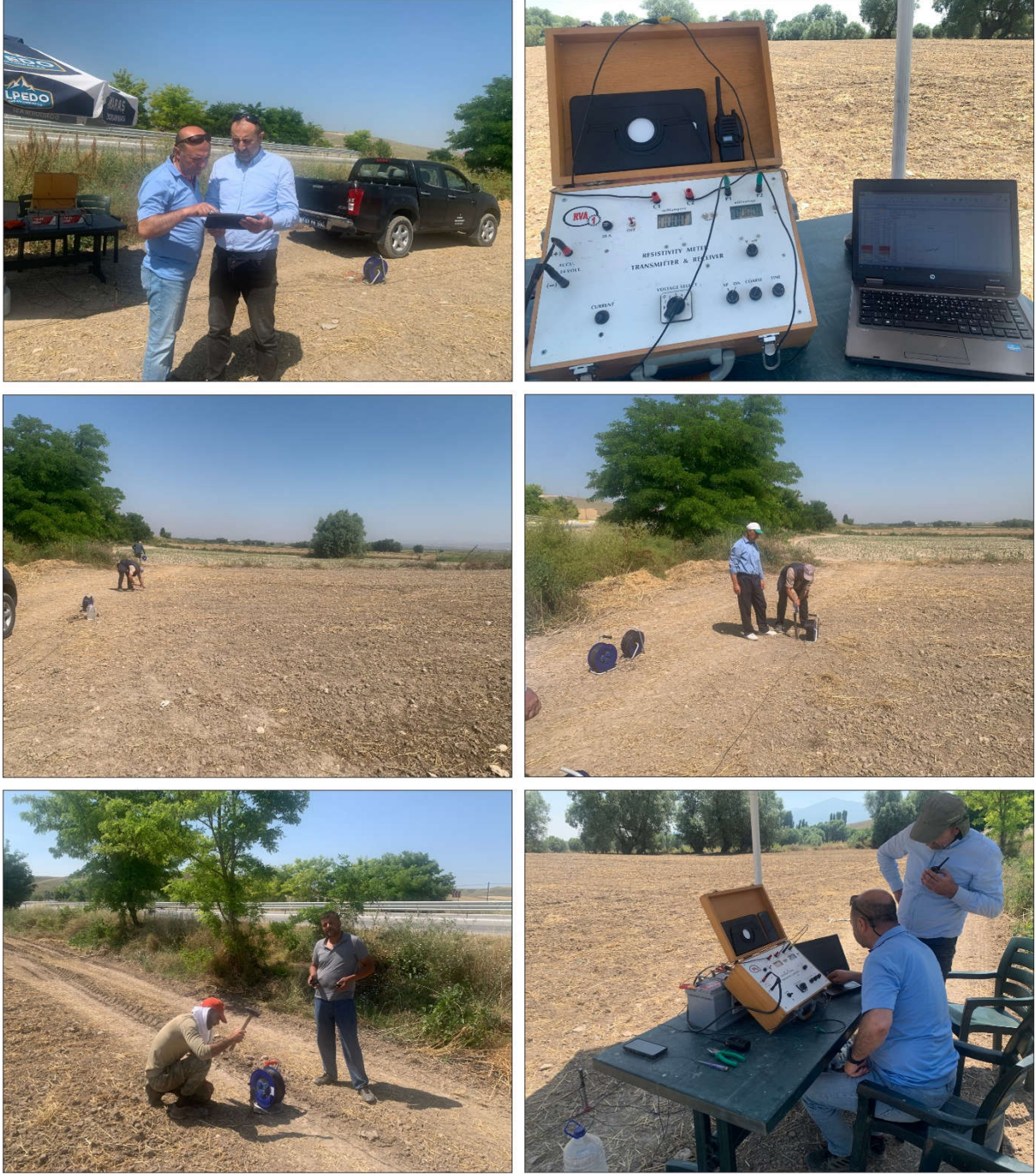
Şekil 4.9. Doğru akım öz direnç (DAÖ) yönteminde ölçüm alım aşamaları
